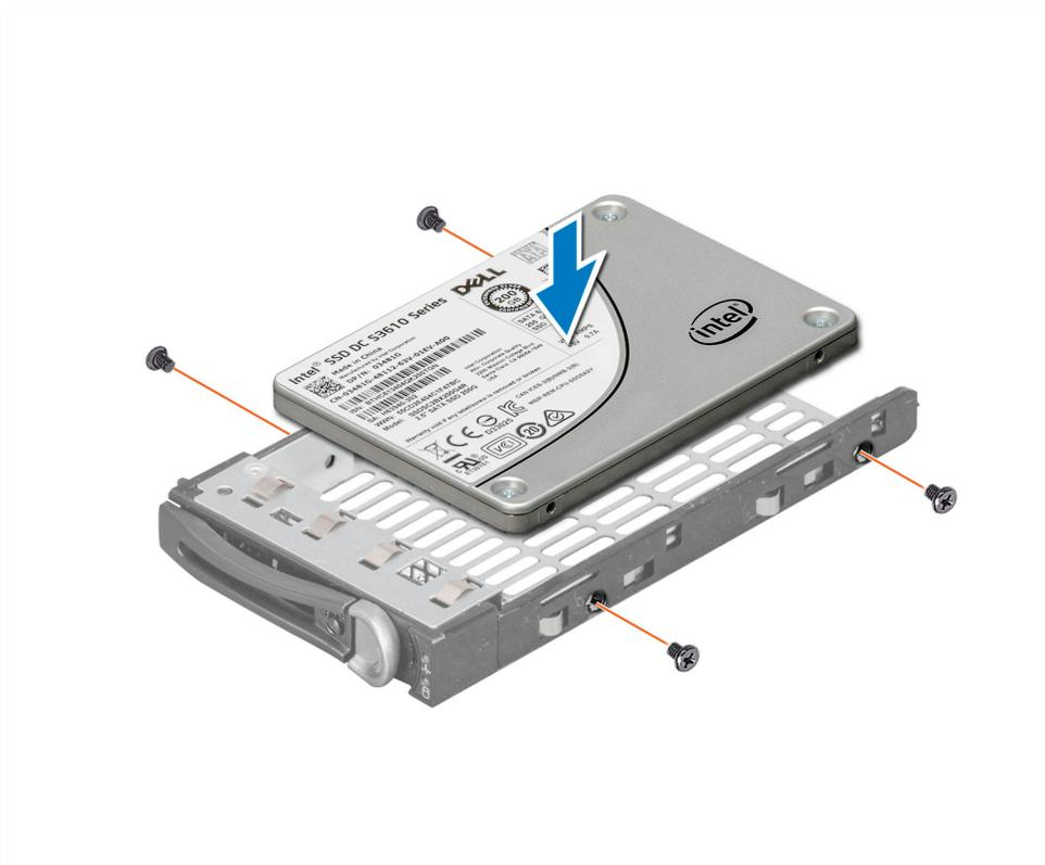
Figure 28. Installation d'un disque dur dans un support de disque dur
